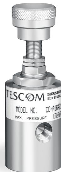
TESCOM CCシリーズ絞りバルブは、68.9 MPa / 10,000 psigの定格で、シートとステムの摩耗を減らすために非回転式ステムが含まれます。遮断から全開まで20回転を超えるため、流量制御に優れています。
