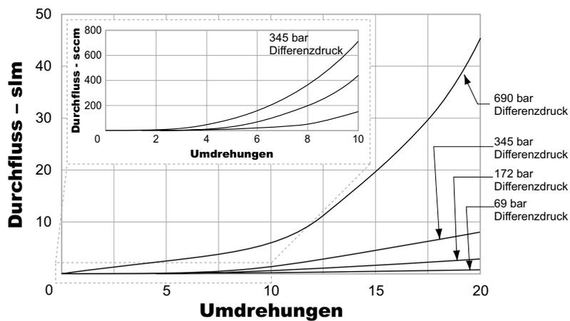
Durchfluss/Umdrehungen - getestet bei 3,4 bar
