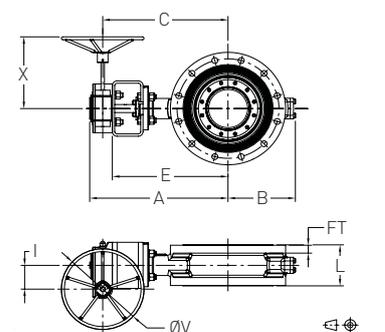
注:DN 80~150の範囲の直径はPN 40のみで利用可能です。ただし、PN 40バルブボディはPN 25パイプフランジに組み付けることができます。
