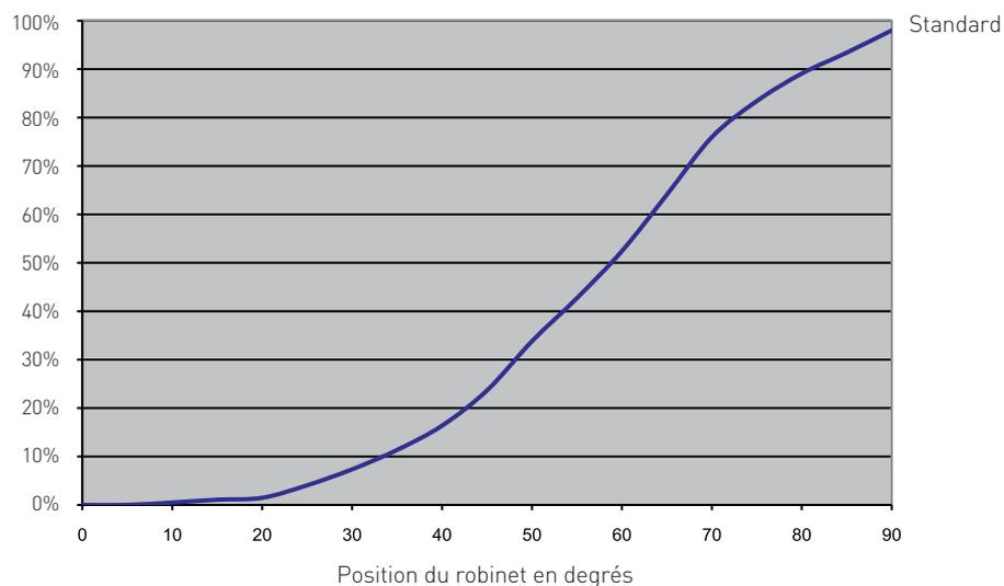
Robinet NXR de DN 80 doté d'un siège standard
