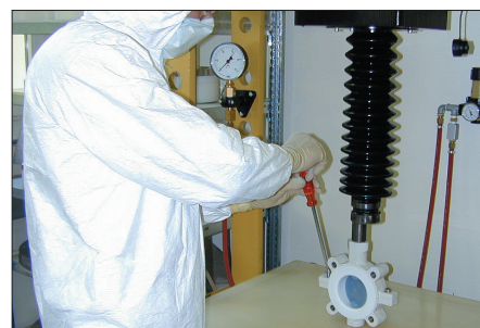
Montage van de afsluiter in een stofvrije ruimte
