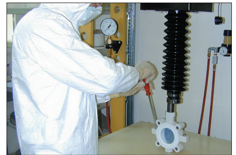
Venttiilin kokoonpano puhdistilassa
