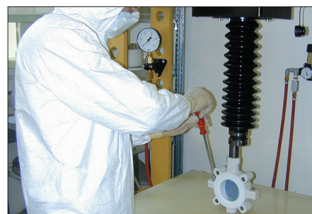
Montaż zaworów w pomieszczeniu czystym
