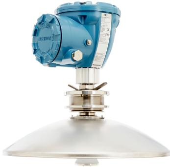
O Rosemount 5900C com antena parabólica é um medidor de nível por radar sem contato. Esta é a antena ideal para a instalação em tanques com tetos fixos e sem tubo acalmador. Pode ser instalada nas tampas da entrada de inspeção e próxima à parede do tanque devido ao feixe estreito do radar e a elevada relação sinal/ruído. Em alguns casos, pode ser instalado em tanques com tetos flutuantes para medir a distância até a placa de destino no teto flutuante.
