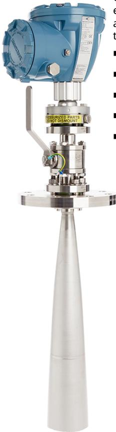
O Rosemount 5900C com antena para GPL/GNL é um medidor de nível por radar sem contato, para medição em gases liquefeitos pressurizados ou criogênicos. Os sinais do radar são transmitidos dentro do tubo acalmador, o que possibilita que o medidor tenha um eco suficientemente forte até mesmo em condições turbulentas, como uma superfície em ebulição.
