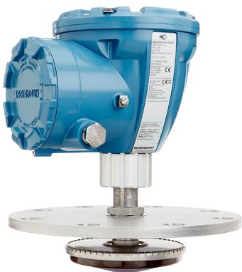
O Rosemount 5900C com antena array é um medidor de nível por radar sem contato, para medição com tubo acalmador. Disponível em duas versões, alçapão fixo ou articulado. As aplicações normalmente são em tanques de petróleo bruto com tetos flutuantes e tanques de gasolina/produto com ou sem tetos flutuantes internos.
