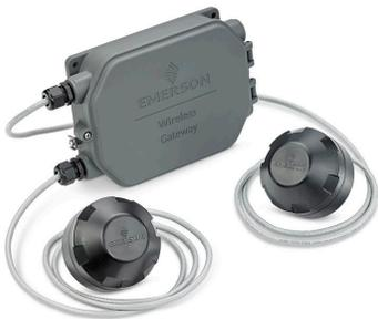
Gerenciador de rede oferecendo uma interface entre dispositivos de campo e o software Rosemount TankMaster ou o sistema DCS/Host na sala de controle. Projetado com segurança, escalabilidade e confiabilidade de dados líderes do setor. Projetados para se conectar facilmente a sistemas host legados, dispositivos adicionais podem ser adicionados rapidamente sem a necessidade de configuração dos caminhos de comunicação.
