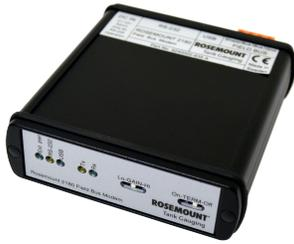
O modem Rosemount 2180 Fieldbus é usado para conectar o barramento de campo TRL2 com os dispositivos de campo de medição de tanques Rosemount ou com o Rosemount 2460 Hub do sistema ao PC do Rosemount TankMaster na sala de controle. Ele é conectado ao PC utilizando a interface USB ou RS232. O modem tem LEDs para indicar que está aceso e há comunicação e, se necessário, switches no painel dianteiro para definir o ganho e a terminação. O kit de montagem permite o encaixe em um trilho DIN padrão.
