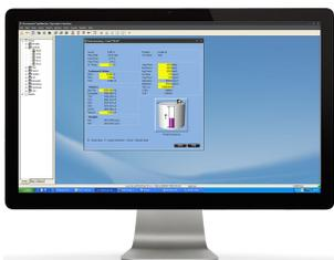
O Rosemount TankMaster é um poderoso pacote de software de gerenciamento de estoque, fácil de usar, baseado em Windows™, que coleta dados de medição de tanques em tempo real, como nível, temperatura, nível da interface de água e pressão.
