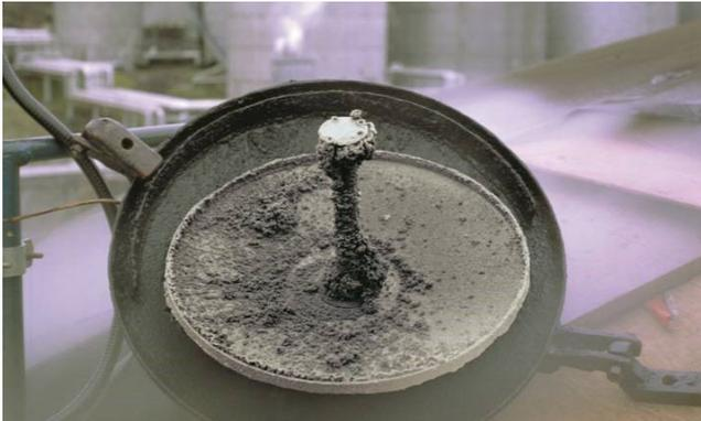
O Rosemount série 5900 com antena de rede de tubos fixos utiliza a tecnologia modo de baixa perda, que transmite ondas do radar próximas à linha do centro do tubo. Esta tecnologia praticamente elimina a degradação de sinal e precisão causada por ferrugem e depósitos de produto dentro da parede do tubo.
