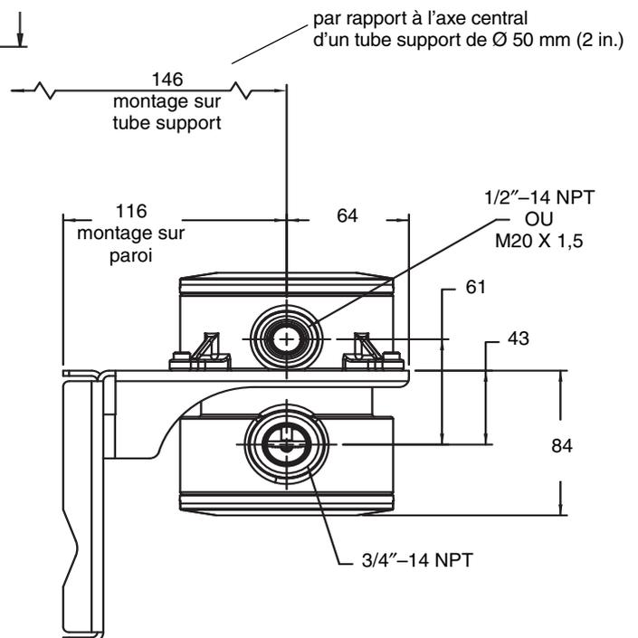
*Ces dimensions s'appliquent uniquement si la platine processeur est déportée du capteur. Pour les dimensions d'une platine processeur intégrée au capteur, consulter la fiche de spécifications du capteur.*
