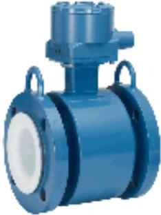
Tous les tubes de mesure à brides sont fabriqués en acier inoxydable et en acier au carbone et sont soudés afin d'assurer un joint hermétique contre l'humidité et les contaminants. Les tailles varient de ½ po (15 mm) à 36 po (900 mm). Le boîtier étanche assure une fiabilité maximale du tube de mesure en protégeant les composants internes et le câblage contre les environnements les plus hostiles.
