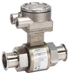
Le capteur aseptique 8721 est spécifiquement conçu pour répondre aux exigences de l'agroalimentaire et de la bio-industrie. Le capteur entièrement soudé et de plein diamètre est fabriqué avec des matériaux conformes aux exigences de la FDA (agence américaine de sécurité alimentaire et sanitaire). Il est autorisé à porter le symbole 3-A (Autorisation n°1222). Il est disponible dans des tailles de ½" à 4" (15 à 100 mm) de diamètre et dans un large choix de raccords de procédé industriel standard.
