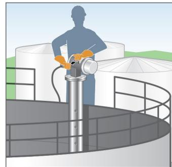
Desconecte o cabeamento existente.
