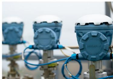
La confiabilidad es fundamental en aplicaciones de almacenamiento refrigeradas. La votación 2oo3 con redundancia triple es una solución frecuente para mediciones de nivel.
