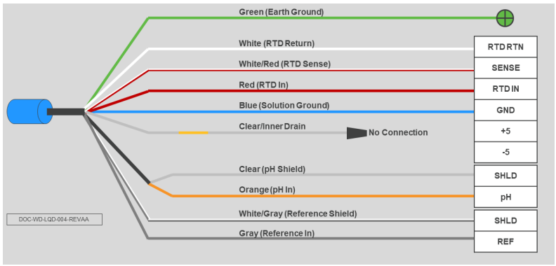
Figura 3-4: Cableado del sensor de pH/ORP Rosemount 396P, 396PVP, 396RVP, 3300HTVP, 3400 HTVP, 3500P, 3500VP, 3900 o 3900VP sin preamplificador a transmisor Rosemount 56, 1056, 1057, o 1058
