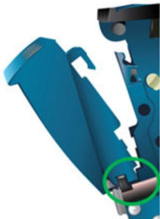
2. Girar los ganchos de plástico para que queden adecuadamente acoplados en la pieza de plástico de soporte.
