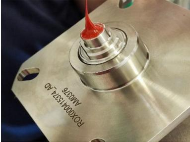
2. Posizionare il dispositivo sulla presa di montaggio, assicurandosi che i perni della presa di montaggio passino attraverso i fori sulla flangia del dispositivo. Spingere il dispositivo finché la guida d'onda non entra in contatto con il tubo e verificare che il Loctite 5990 si sia distribuito uniformemente.
