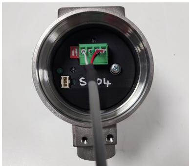
2. Collegare il cavo di configurazione al tablet o al PC su cui verrà eseguita l'applicazione di commissioning.
