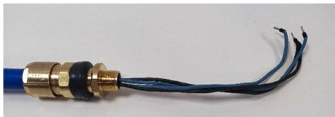
2. Far passare i fili attraverso la custodia del dispositivo. Serrare il premistoppa sulla custodia finché non sia completamente a contatto con la custodia del dispositivo. Utilizzando una chiave da 24 mm, assicurarsi che il premistoppa sia serrato completamente secondo le istruzioni del produttore.
