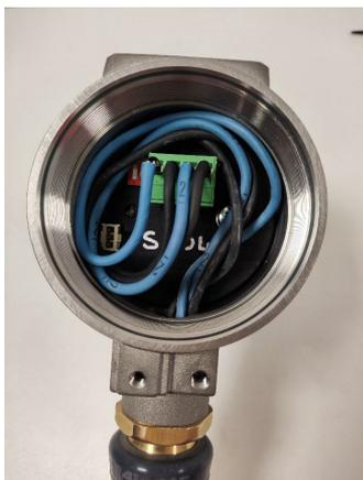
5. Riposizionare il coperchio sulla custodia del dispositivo. Utilizzando la chiave del coperchio, serrare il coperchio fino a quando non sia più possibile stringerlo ulteriormente (il coperchio deve bloccarsi sulla custodia del dispositivo).
