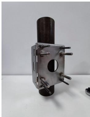
Una volta completata l'installazione del supporto su un tubo piccolo, procedere a [Installazione del monitor acustico di particelle Rosemount SAM42 sulla presa di montaggio](#) per installare il dispositivo sulla presa di montaggio.
