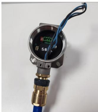
3. Rimuovere il connettore dalla presa all'interno del dispositivo. Collegare i quattro conduttori nel connettore assicurandosi che corrispondano alle connessioni di alimentazione e dati dal lato del sistema di controllo. I collegamenti da sinistra a destra sono: Comunicazione -ve, Comunicazione +ve, Alimentazione -ve, Alimentazione +ve.
