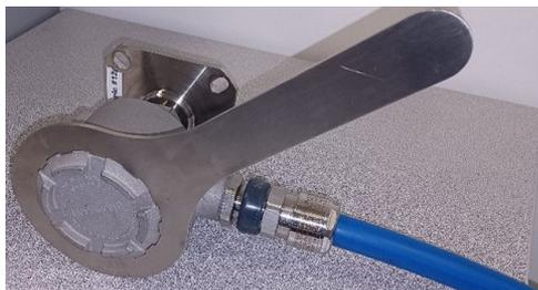
Il monitor acustico di particelle Rosemount SAM42 è ora installato sulla superficie del tubo. Il compito successivo è quello di mettere in servizio e calibrare il dispositivo per l'uso. Per ulteriori informazioni, fare riferimento a [Configurazione e commissioning del monitor acustico di particelle Rosemount SAM42](#).
