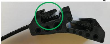
7. Tendere a mano la cinghietta in modo che trattiene delicatamente in posizione il sensore. Se necessario, regolare la posizione del sensore per assicurarne il corretto allineamento intorno alla circonferenza del tubo. In caso di sensori multipli su un'unica cinghietta, lasciare uno spazio tra le solette di sensori adiacenti.
