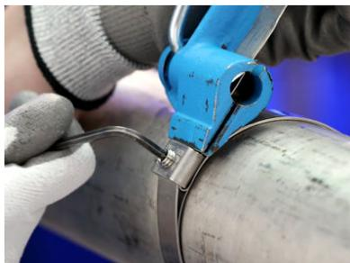
7. Retirer l'appareil à tension.
