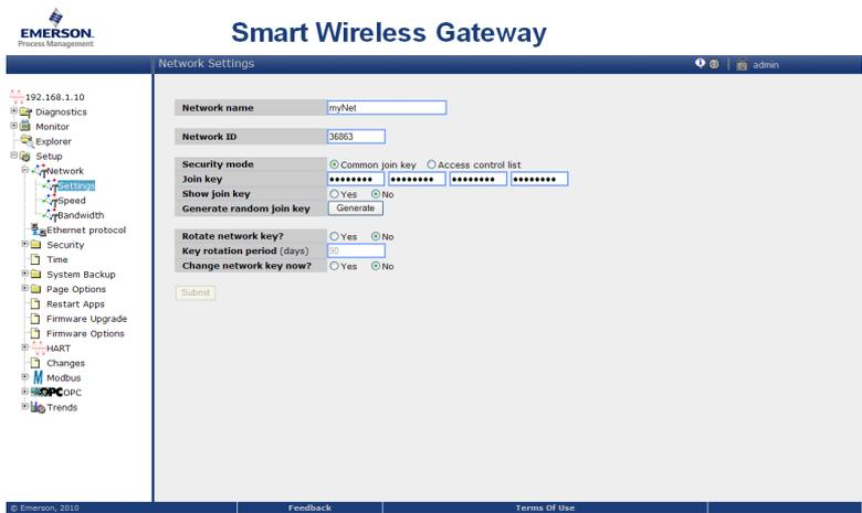
Il est possible de modifier le n° d'identification du réseau et la clé de jonction dans l'appareil sans fil à l'aide de la séquence d'accès rapide suivante.
