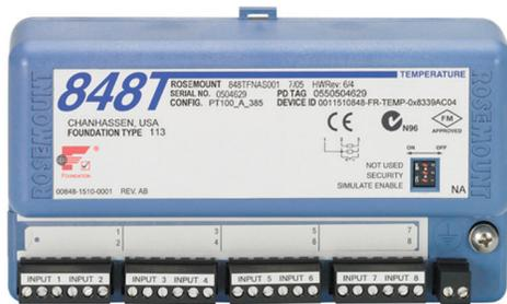
El modelo Rosemount 848T proporciona una solución de bajo costo para mediciones de alta densidad. El transmisor acepta ocho entradas de sensores configurables de forma independiente y se puede montar cerca del proceso para mejorar la calidad de los datos. La arquitectura del FOUNDATION Fieldbus permite transmitir hasta 128 mediciones de temperatura en una sola línea de fieldbus H1.
