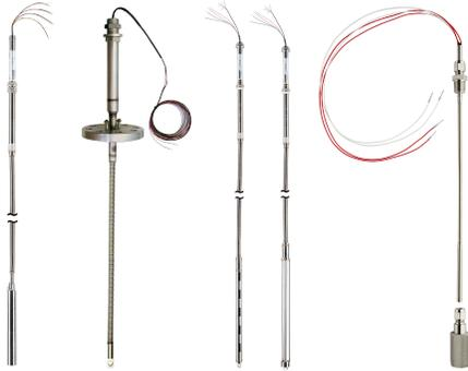
Sensores de temperatura calibrados de tres o cuatro hilos y medición de nivel de agua libre. Hasta 16 elementos de punto Pt-100 por sensor/transmisor. Solo los sensores completamente sumergidos determinan la temperatura del producto. Cada sensor está conectado a un transmisor Rosemount 2240S. El Rosemount 614 está diseñado específicamente para mediciones de temperatura en tanques criogénicos y refrigerados.
