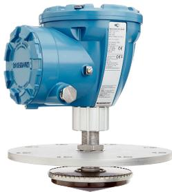
El medidor de nivel por radar Rosemount 5900C otorga una precisión del instrumento de  $\pm 1$  mm (0,04 in). Por lo general, se combina con sensores de temperatura de múltiples puntos de alta precisión para cálculos de volumen neto. Tiene certificación SIL 2 conforme a IEC 61508.
