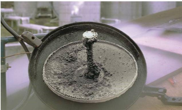
El Rosemount serie 5900 con matriz de antena de tubo tranquilizador utiliza la tecnología Low Loss Mode para transmitir ondas de radar cerca de la línea central del tubo. Esta tecnología prácticamente elimina la degradación de señal y de precisión provocada por el óxido y los depósitos de producto dentro de la pared de la tubería.
