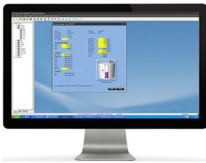
Rosemount TankMaster es un paquete de software de gestión de inventario basado en Windows™, potente y fácil de usar, que recopila en tiempo real datos de medición de tanques como nivel, temperatura, nivel de interfaz de agua y presión.
