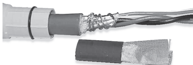
Figur 3-13: Skärmad värmekrympning som täcker de exponerade biledarna
