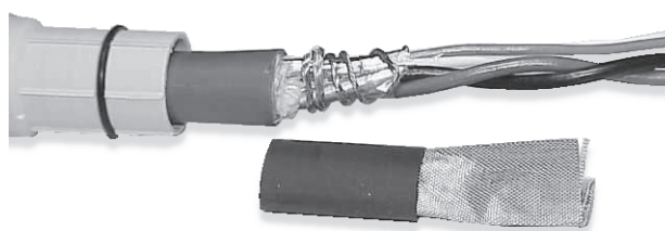
Figur 3-6: Skjermledningene viklet to ganger rundt den eksponerte folieskjermer
