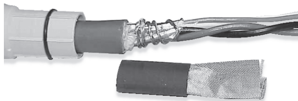
Figur 3-7: Skjermet varmekrymping dekker eksponerte skjermledninger
