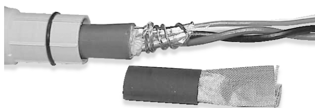
Rysunek 3-6: Przewody uziemienia dwukrotnie okręcić wokół odsłoniętej folii
