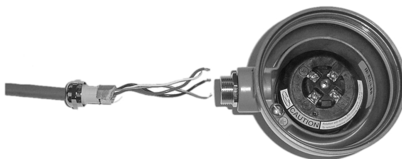
Figur 3-7 Kabelafslutningskerne og MVD-modulindkapsling
