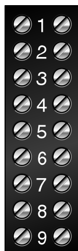
Figura 3-20: Terminales de todos los sensores modelos D y DL, y de los sensores serie F antes de 2005
