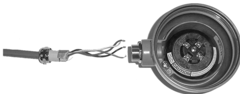
Figur 3-7 Kabelgjennomføring og kjerneprosessorhus
