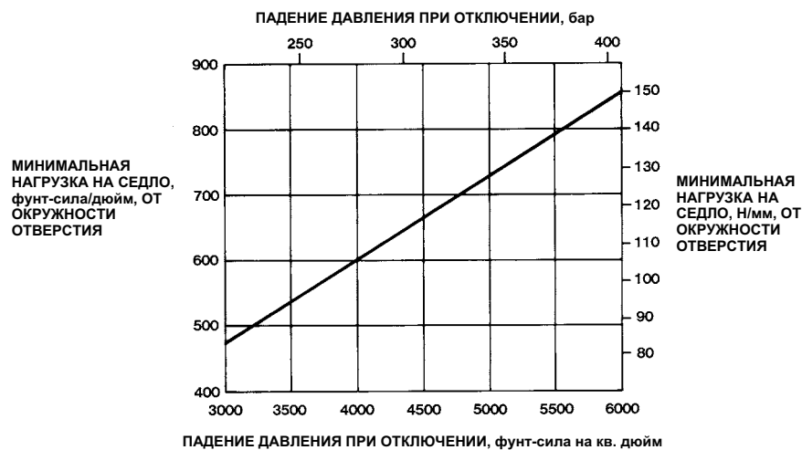
Рис. 2. Рекомендуемая минимальная нагрузка на седла для всех конструкций
