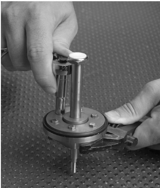
**Figure 4.** Utiliser l'outil fourni ou l'ensemble siège de ressort (n° 4) et tige (n° 2) pour aligner le dispositif de retenue de disque (n° 8)
