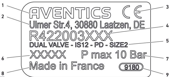
3 Typenschild | Plaque signalétique | Name plate | Targhetta dati | Placa de características | Typskylt 1: Firmenname | nom de la société | Company name | nome azienda | Nombre de la empresa | Tillverkarnamn 2: Firmenadresse | adresse de la société | Company address | indirizzo azienda | Dirección de la empresa | Tillverkarens adress 3: CE-Kennzeichnung | marquage CE | CE mark | marchio CE | Marcado CE | CE-märkning 4: Materialnummer | référence | Material number | codice | Número de material | Materialnummer 5: Typenbezeichnung | Désignation | Type designation | denominazione del tipo | Denominación de tipo | Typbeteckning 6: Fertigungsdatum | date de fabrication | Production date | data di produzione | Fecha de fabricación | Tillverkningsdatum 7: Maximaldruck | pression maximale | Maximum pressure | pressione massima | Presión máxima | Maximalt tryck 8: Herstellungsland | pays de fabrication | Country of manufacture | paese di produzione | País de fabricación | Tillverkningsland 9: Verantwortliches Werk | usine responsable | Responsible plant | stabilimento responsabile | Fábrica responsable | Ansvarig fabrik
