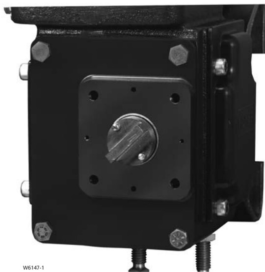
BARRA DO TIRANTE, PLACA DE MONTAGEM REMOVIDA
