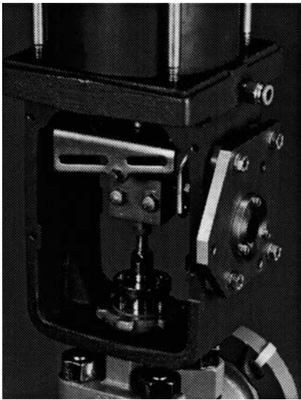
Figura 10. Placa de montagem posicionada no atuador
