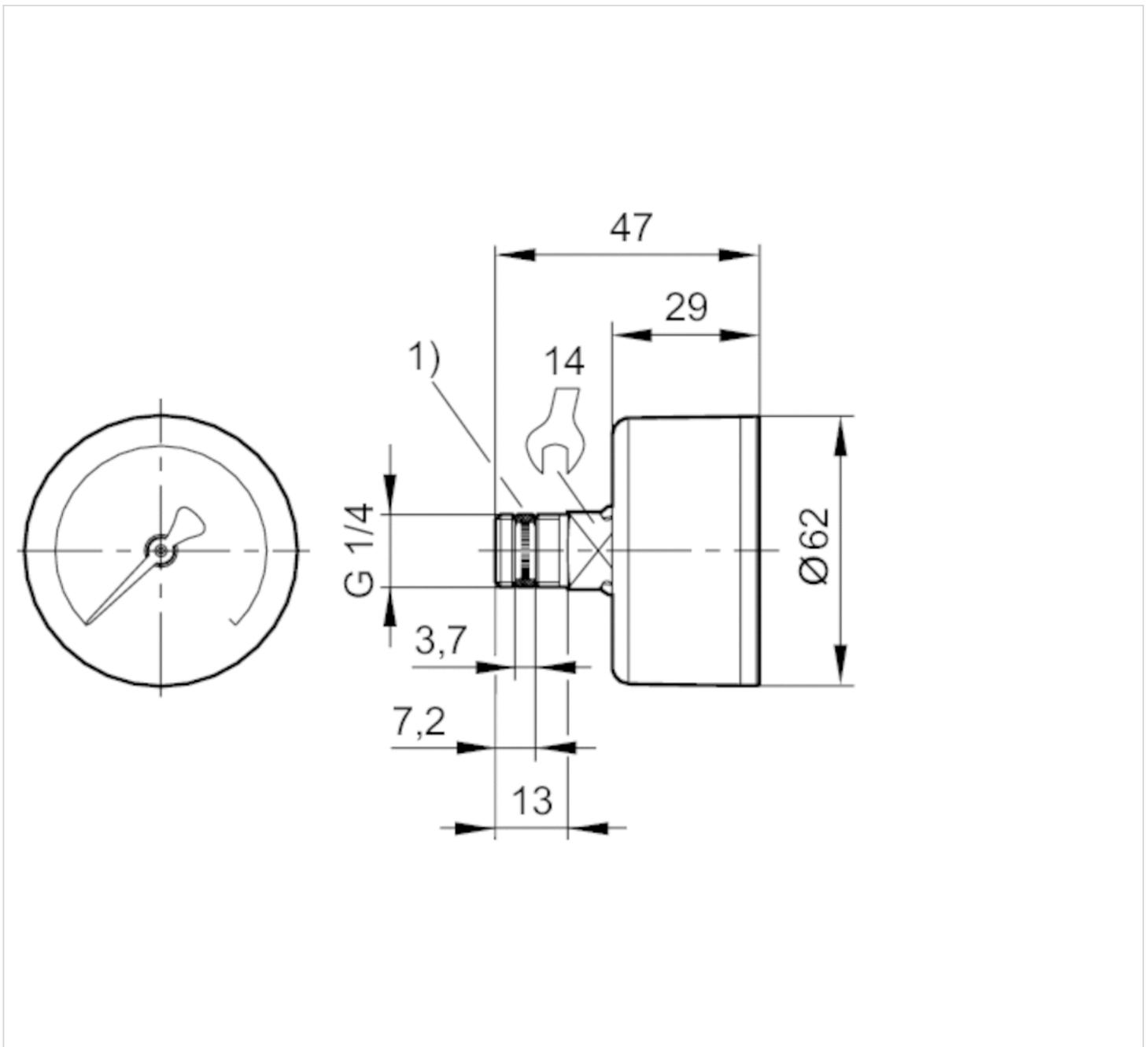
1) montierte Dichtung
