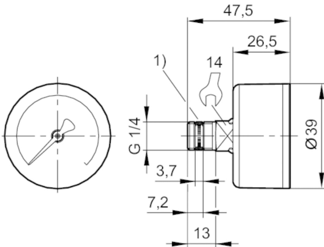
1) montierte Dichtung
