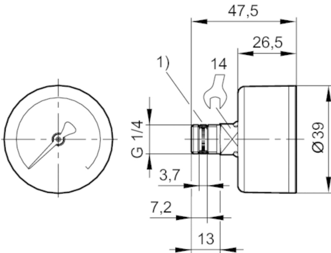
1) montierte Dichtung
