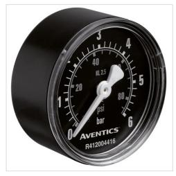
**Bauart** Rohrfedermanometer Normierung EN 837-1 2,5 Güteklasse Umgebungstemperatur min./max. -40 ... 60 °C Medium Druckluft Einheit Hauptskala (aussen) bar Farbe Hauptskala (außen) Weiß Einheit Nebenskala (innen) psi Farbe Nebenskala (innen) Grau Farbe Hintergrund Schwarz Farbe Zeiger Weiß
