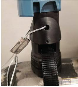
10. Das blanke Ende des Sicherungsseils in den Gripper einführen und den Gripper ca. 6 in. (15 cm) vom blanken Ende nach innen schieben.
