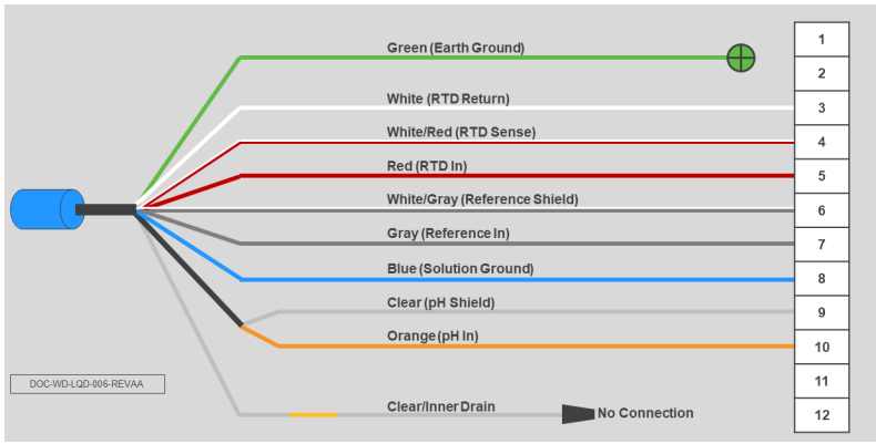
Abbildung 3-6: Verkabelung zwischen Rosemount 396P, 396PVP, 396RVP, 3300HTVP, 3400 HTVP, 3500P, 3500VP, 3900 oder 3900VP pH/ORP-Sensor ohne Vorverstärker und Rosemount 5081 Messumformer
