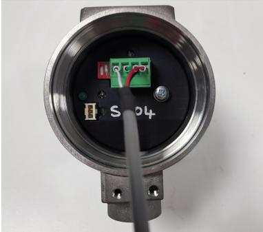
2. Das Konfigurationskabel an das Tablet oder den PC anschließen, auf dem die Inbetriebnahme-App ausgeführt wird.
