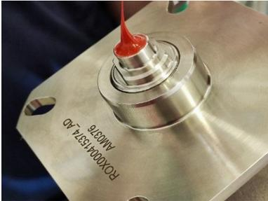
2. Das Messsystem auf die Montagebuchse setzen und darauf achten, dass die Bolzen der Montagebuchse durch die Löcher am Flansch des Messsystems führen. Das Messsystem herunterdrücken, bis der Wellenleiter auf das Rohr trifft, und prüfen, ob sich das Loctite 5990 gleichmäßig verteilt hat.
