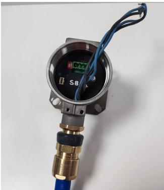
3. Das Anschlusskabel aus der Buchse im Messsystem ziehen.
