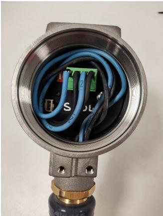
5. Den Deckel wieder auf das Gehäuse des Messsystems setzen. Den Deckel mit dem Deckelschlüssel bis zum Anschlag festziehen (der Deckel sollte bündig mit dem Gehäuse des Messsystems abschließen).
