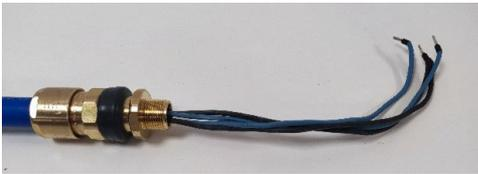
2. Die Kabel durch das Gehäuse des Messsystems führen. Die Kabelverschraubung am Gehäuse festziehen, bis sie vollständigen Kontakt mit dem Gehäuse des Messsystems hat. Mit einem 24-mm-Schraubenschlüssel sicherstellen, dass die Kabelverschraubung gemäß Herstelleranweisungen fest angezogen ist.
