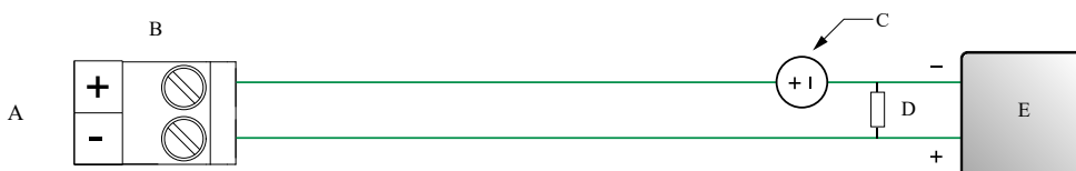
Figura 4-9: Fiação de DO com alimentação externa
