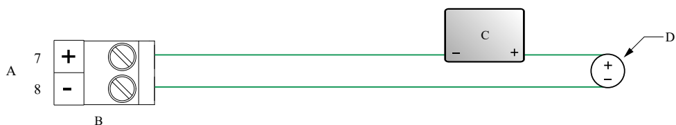
Figura 4-24: Fiação de entrada em mA (alimentada externamente)
