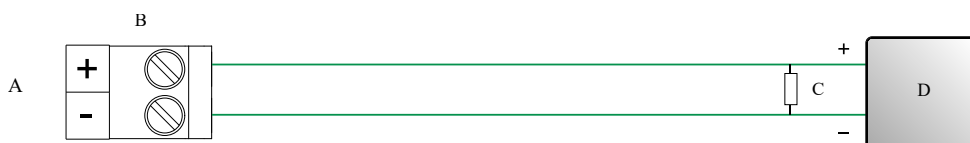
Figura 4-3: Fiação de saída em mA (alimentada internamente)
