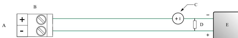
Figura 4-18: Fiação de saída discreta (alimentada externamente)
