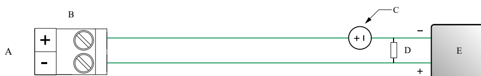
Figura 4-4: Cableado DO con alimentación externa
