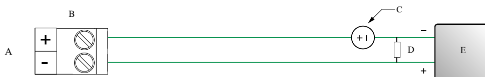
Figura 4-3: Cableado FO con alimentación externa
