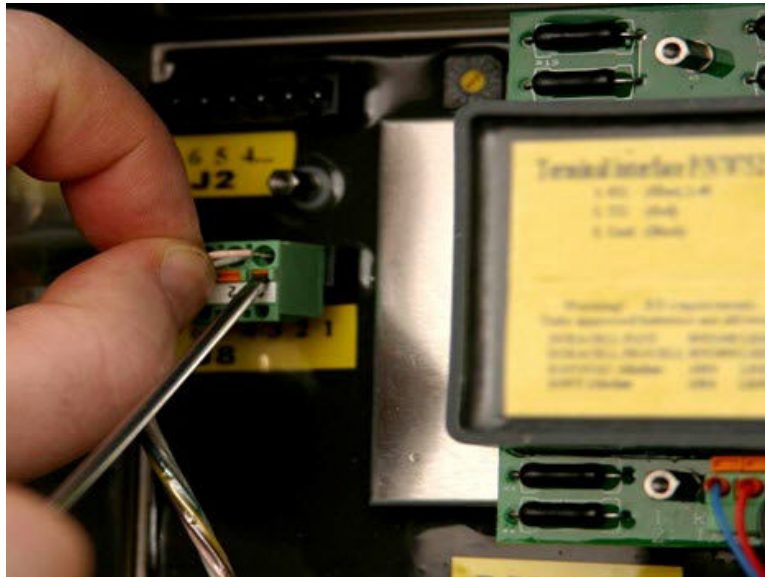
Figura 4-2: Terminação do cabo dentro do registrador
