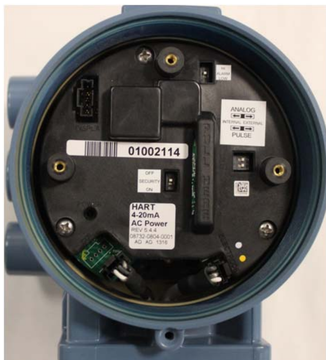
Figura 3-1. Pila e interruptores de hardware de la electrónica del transmisor Rosemount 8732EM
