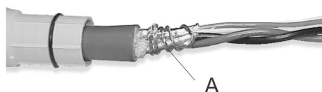
A. Przewody odprowadzające owinięte wokół ekranu
