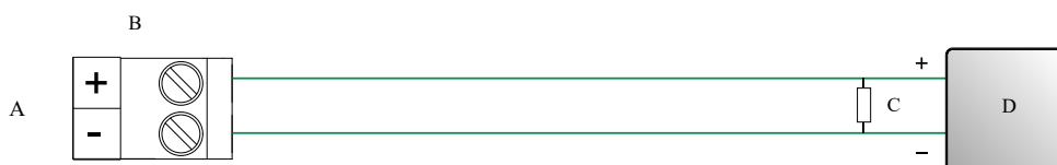
Figura 4-7: Cablaggio DO ad alimentazione interna
