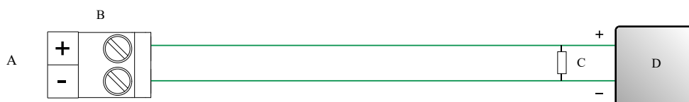
Figura 4-1: Cablaggio di uscita mA ad alimentazione esterna
