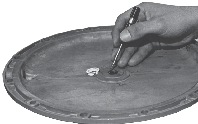
Рисунок 5. Проверка направляющей втулки и уплотнительного кольца штока
