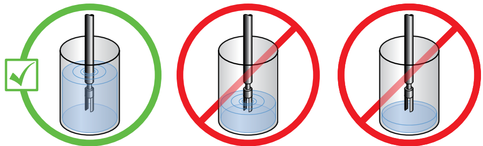
Figura 2-14: Posicionamento do medidor (imerso no fluido)
