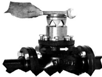
SUBSTITUIÇÃO DE PEÇAS DO TRIM NO SITE USANDO O CORPO COMO UM SUPORTE DE INSTALAÇÃO
