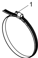
Fig. 6.34: Cinta de sujeción con cierre tensor
