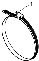
Fig. 6.53: Cinta de sujeción con cierre tensor
