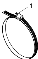
Fig. 6.59: Cinta de sujeción con cierre tensor
