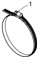
Fig. 6.28: Cinta de sujeción con cierre tensor
