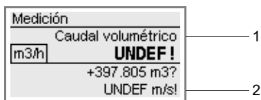
Fig. 13.1: Velocidad de flujo fuera del rango de validez
