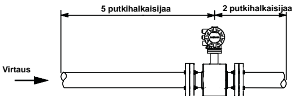
Kuva 3. Tulo- ja lähtöpuolen suorien putkiosuuksien halkaisijat
