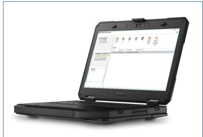
Ноутбук DeltaV в защищенном корпусе с Инженерным ПО контроллера PK.
