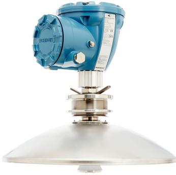
Das Rosemount 5900C mit Parabolantenne ist ein berührungsloses Radar-Füllstandsmesssystem. Die Parabolantenne ist die erste Wahl für die Installation auf Tanks mit Festdächern ohne Führungsrohr. Aufgrund des schmalen Radarstrahls und des hohen Rauschabstands kann das System an Mannlochdeckeln und nahe der Tankwand installiert werden. In bestimmten Fällen kann das System auch an Schwimmdächern installiert werden, um den Abstand zu einer Zielplatte am Schwimmdach zu messen.
