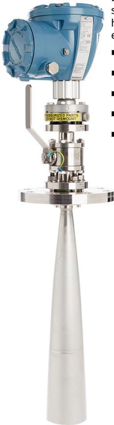
Das Rosemount 5900C mit LPG/LNG-Antenne ist ein erstklassiges, berührungsloses Radar-Füllstandsmesssystem für Messungen von druckbeaufschlagtem oder kryogenem Flüssiggas. Radarsignale werden innerhalb des Führungsrohrs übertragen, wodurch das Messgerät auch unter turbulenten Bedingungen, z. B. einer kochenden Oberfläche, ein ausreichend starkes Echo erhält.
